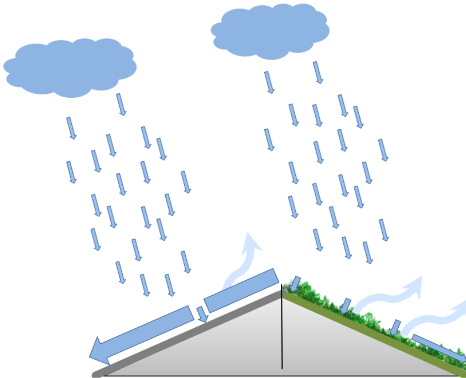
Abbildung 13: Niederschlagsereignis auf ein herkömmlich gedecktes und ein begrüntes Dach. Schematische Darstellung von Oberflächenabfluss, Retentions- und Verdunstungsleistung der unterschiedlichen Dacharten. Grafik: Dr. Sebastian Schmauck, BfN
